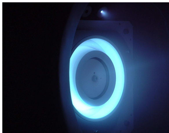
premier tir du moteur plasmique PPS®X000 (doc. Snecma)
